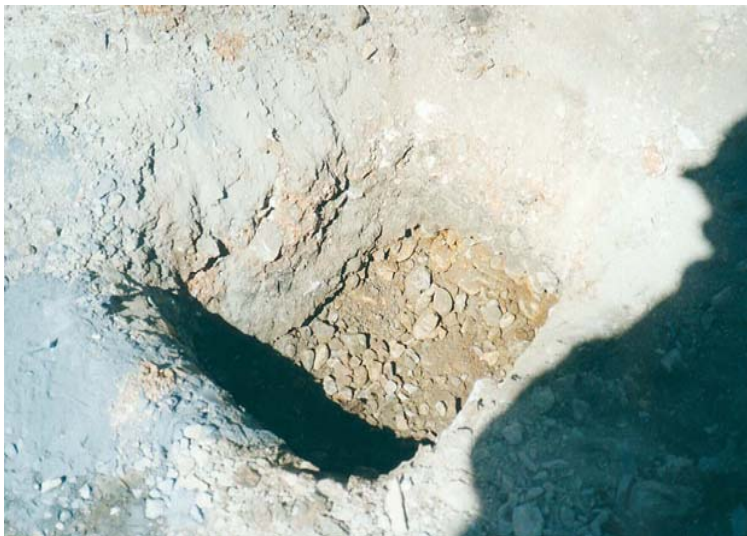
b) Ejemplo de una Calicata Manual (50 - 100 cm de profundidad)
